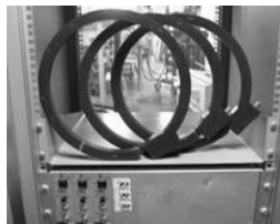
Fig. 3 Vista delle tre bobine di Rogowski.
