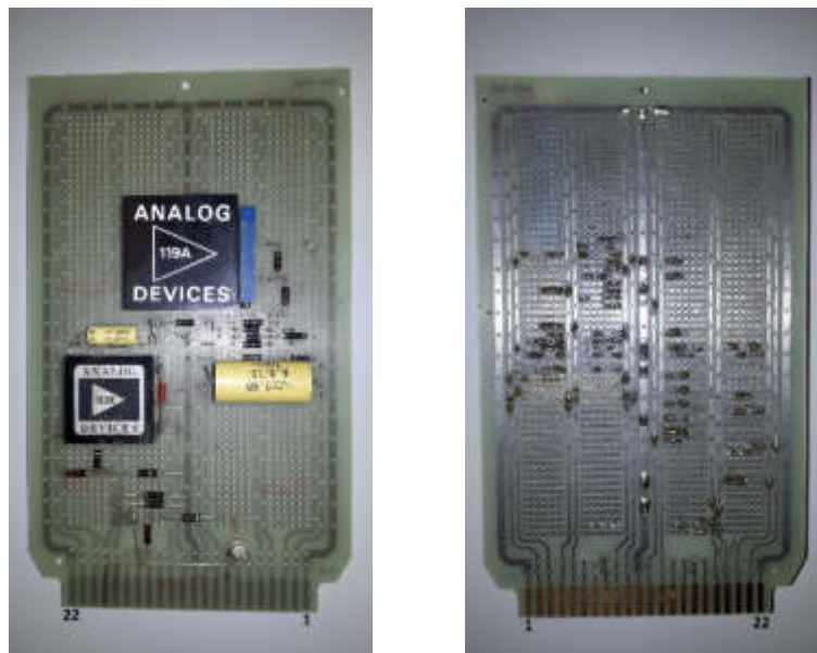
Figura 5: circuito lato componenti e lato saldature
