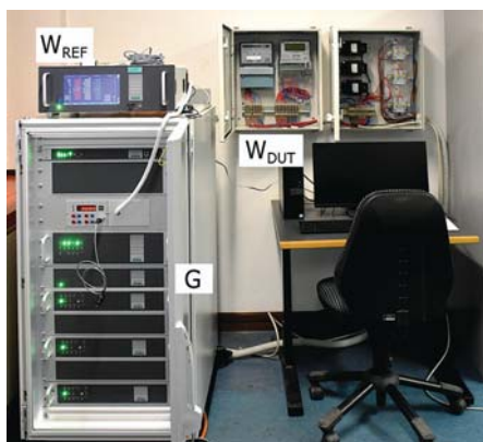
Figura 1 – Il sistema di taratura e verifica di contatori elettrici. G è il generatore di potenza virtuale, composto da un'unità di sintesi di forme d'onda, un amplificatore di tensione a tre canali, tre amplificatori di transconduttanza. W_{REF} è il contatore campione. W_{DUT} è il contatore in taratura, dotato di trasduttori di tensione e corrente (più contatori possono essere connessi in cascata). I modelli in taratura mostrati in figura non sono quelli a cui si riferiscono i risultati mostrati nell'articolo.
