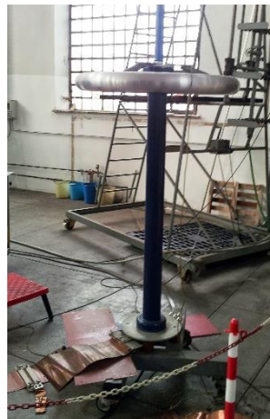
Figura 2 - Divisore capacitivo smorzato HAEFELY R600
