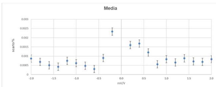
Di seguito si riportano i valori del partitore induttivo. Purtroppo di questo strumento abbiamo solo 2 tarature (1995 e 2014) però conoscendo la eccellente stabilità la taratura si eseguire ogni 20 anni.
