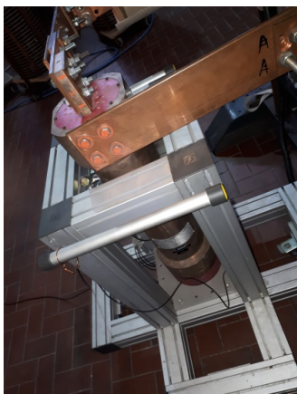
Fig. 1- derivatore compensato per forti correnti transitorie.
