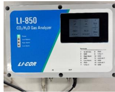
Fig. 1. LI-850 gas Analyser
