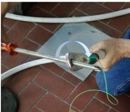
Fig.12. Torsione di un cavo di prova intorno al proprio asse di simmetria.
