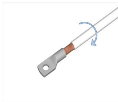
Fig.13. Rotazione di un cavo di prova intorno al piano del capocorda.
