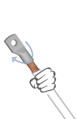
Fig.12. Torsione di un cavo di prova intorno al proprio asse di simmetria.
