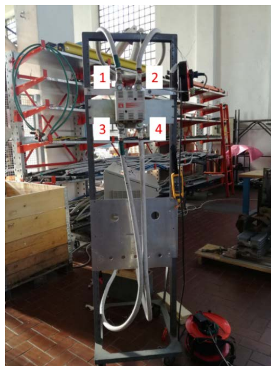
Fig. 35b. Numero dei capicorda coinvolti nelle prove di sovratemperatura.
