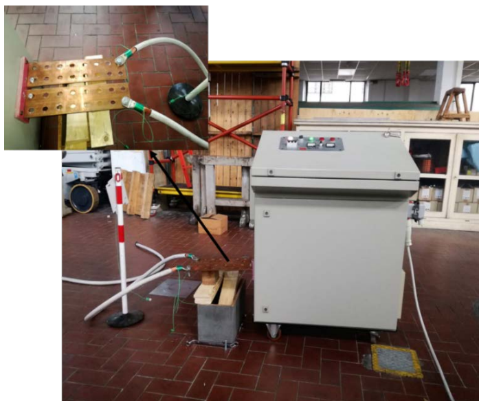
Fig.10 Circuito di misura con zoom del collegamento dei capicorda alle barre di rame.
