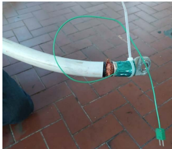
Fig. 36. Posizione della termocoppia per misurare l'aumento di temperatura dei capicorda nelle due prove.
