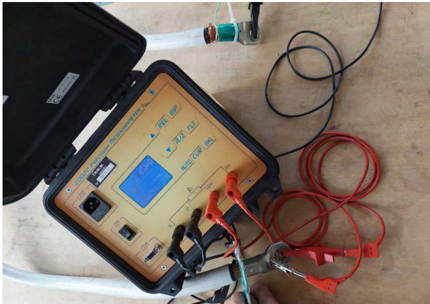
Fig.28. Collegamento del microohmmetro al capocorda per la misura diretta di R_{crimp} .
