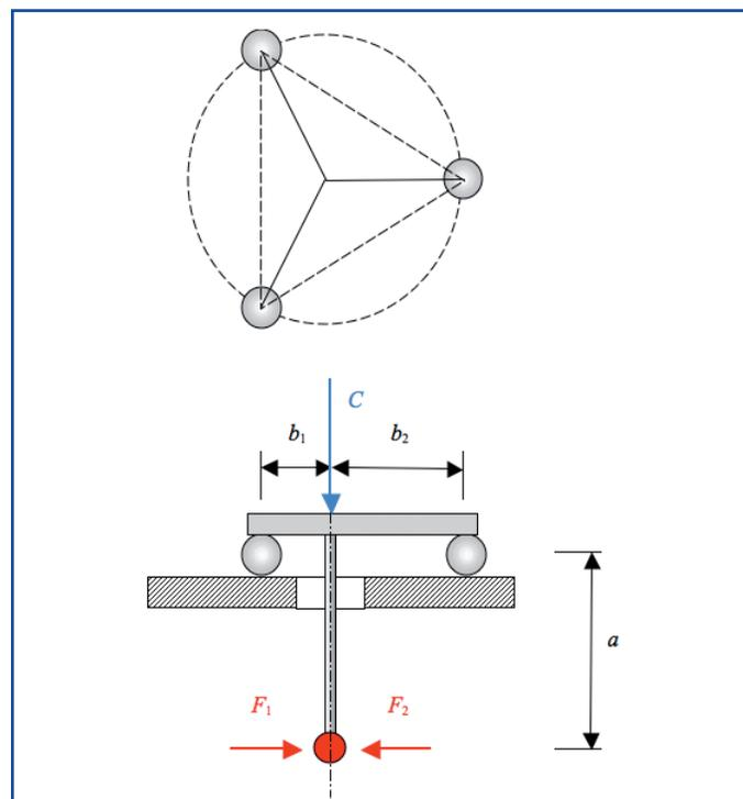
Fig. 4 - Schema di un tipico tastatore *touch trigger*
