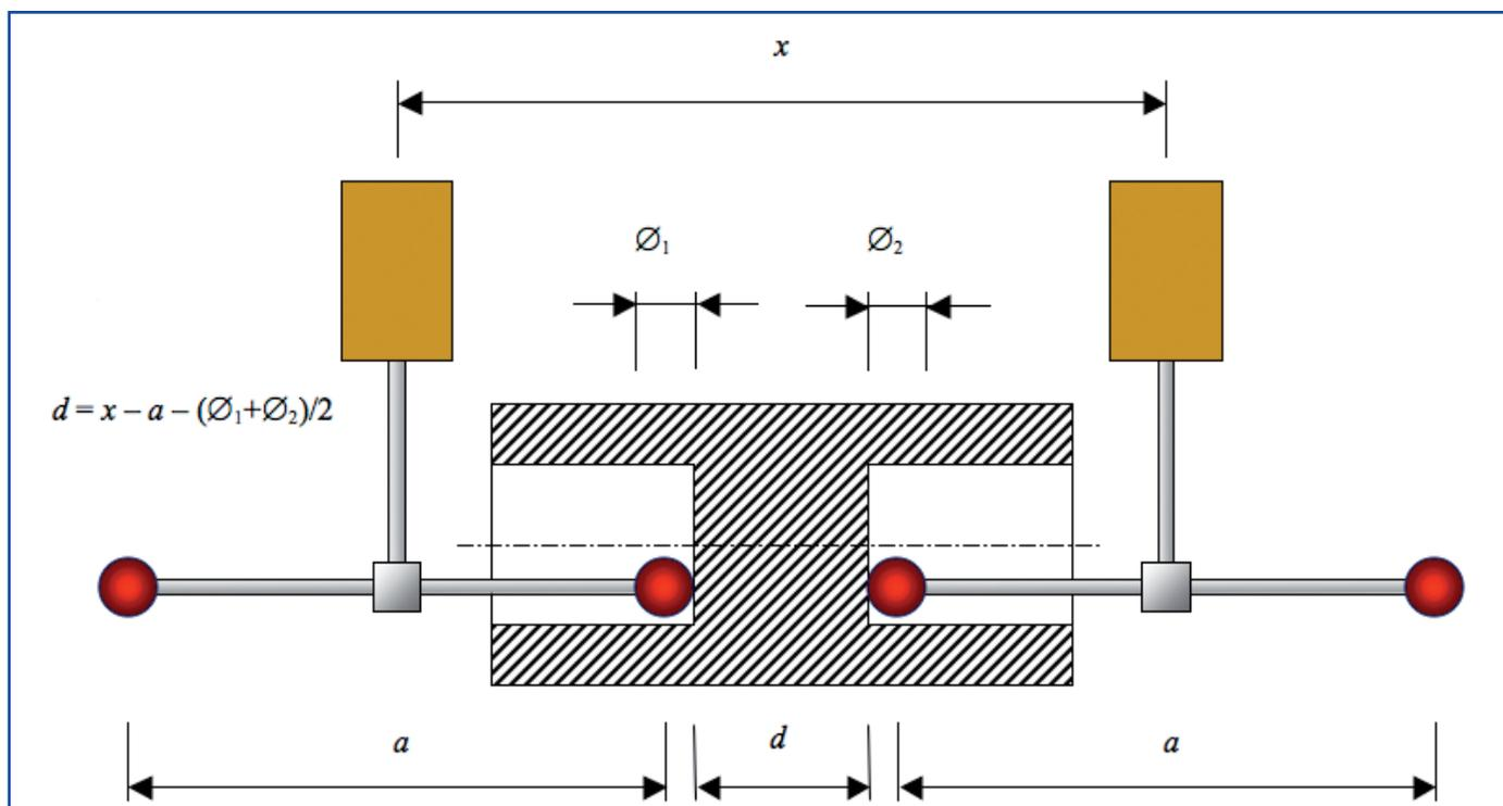
Fig. 5 - Esempio di misurazione con sistema multi stilo: l'offset mutuo,  $a$ , interviene direttamente nella determinazione dello spessore dello spallamento interno,  $d$
