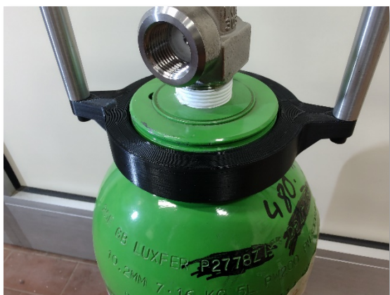
Figura 6 Accoppiamento Anello Bombola
