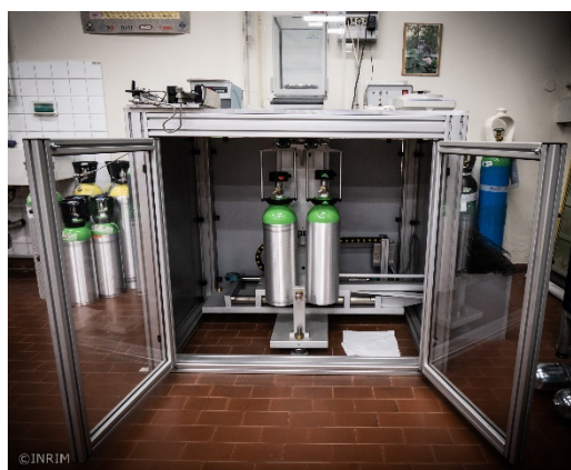
Figura 7 Comparatore Gas Massa
