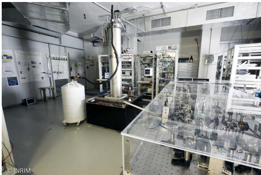
Fig. 2 Il laboratorio INRIM dell'orologio atomico a fontana criogenica di cesio.
