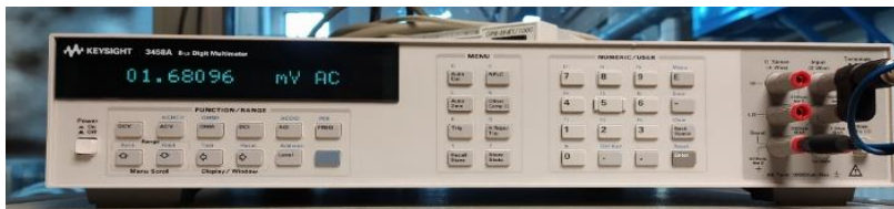
Figura 8 - Multimetro Keysight 3458A collegato allo Shunt
