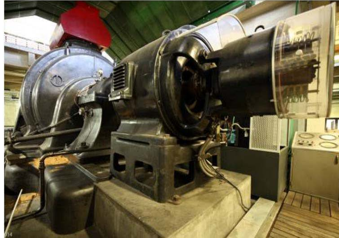
Figura 1 - Generatore di correnti di corto circuito
