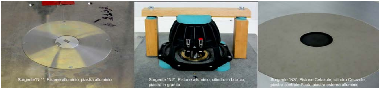
Figura 3 – Le 3 versioni di campione di potenza sonora INRiM.
