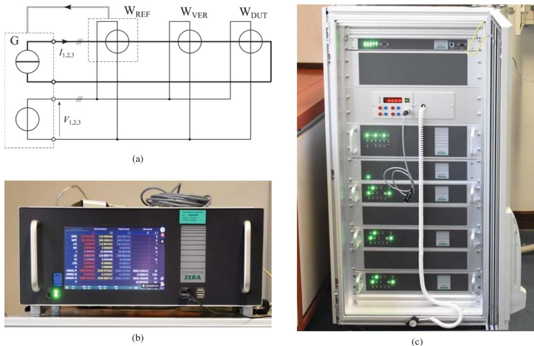
Figura 1: Componenti del sistema di taratura e verifica. 1a schema elettrico semplificato. 1b wattmetro/contatore trifase campione  $W_{REF}$ , ZERA mod. COM5003, classe 0.005 % e capacità di analisi sino alla 40° armonica. 1c generatore trifase G, ZERA mod. MTS310; genera sino a 320 V e 120 A per fase, con fondamentale da 40 Hz a 70 Hz e ampiezza di banda sino a 1 kHz.
